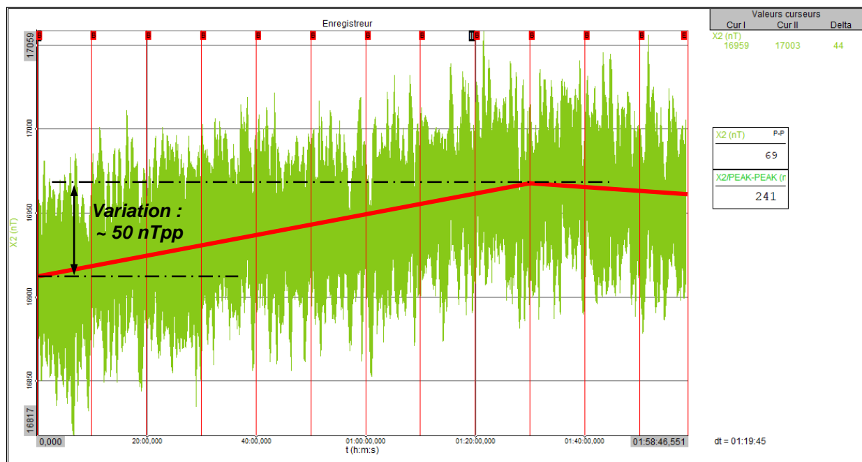
Figure 28. Exemple d'évolution de la composante du signal établie sur plusieurs heures (axe X).
